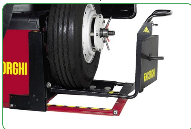
➤ Elévateur doté de manche de sécurité pour empêcher le basculement de la roue et rendre les opérations de manutention plus aisées
